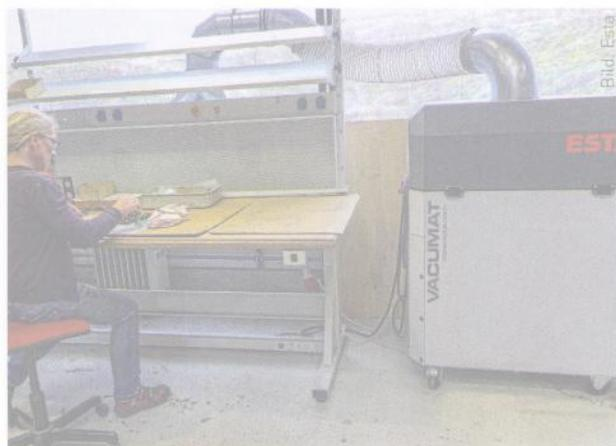
An einem Klebearbeitsplatz saugt ein Vacumat mit Aktivkohlefilter die entstehenden Gerüche und Klebedämpfe ab. Der Vacumat ist über eine Rohr-Schlauch-Leitung mit der Rückwand verbunden und entlässt die gefilterte Luft zurück in den Arbeitsraum.
